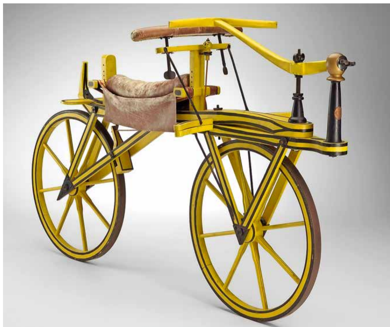
La Laufmaschine du baron Karl Drais: 22 kg, presque tout en bois, avec un timon, un frein à sabot et déjà une plaque de licence. DR
