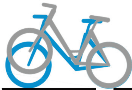
Principe de disposition des vélos avec surélévation alternée de la roue avant
