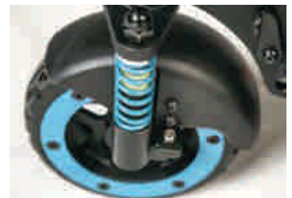
Pour un amorti efficace, il faut un amortisseur à l'avant, mais aussi un à l'arrière.
